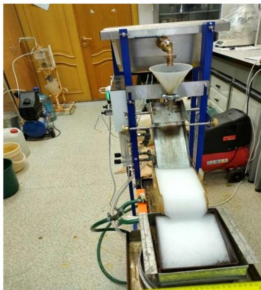
**Рисунок 1 – Пенный сепаратор подготовлен к работе**
