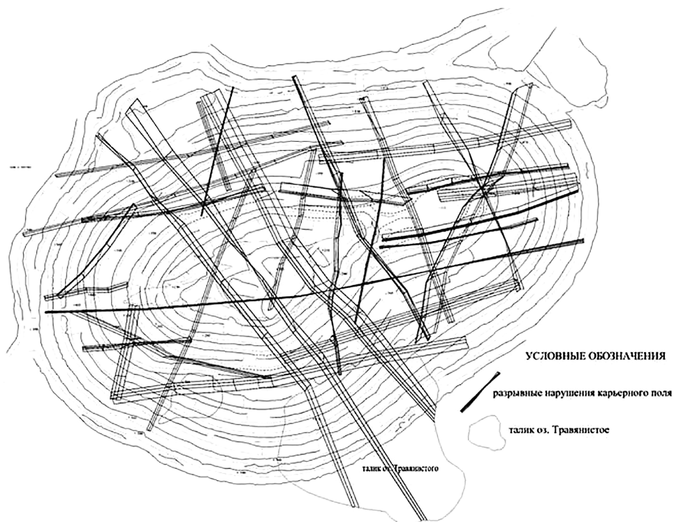
Рис. 1. Тектонические нарушения в пределах карьерного поля трубки «Юбилейная» (по материалам Айхальского ГОКа и съёмки ИЗК СО РАН)
