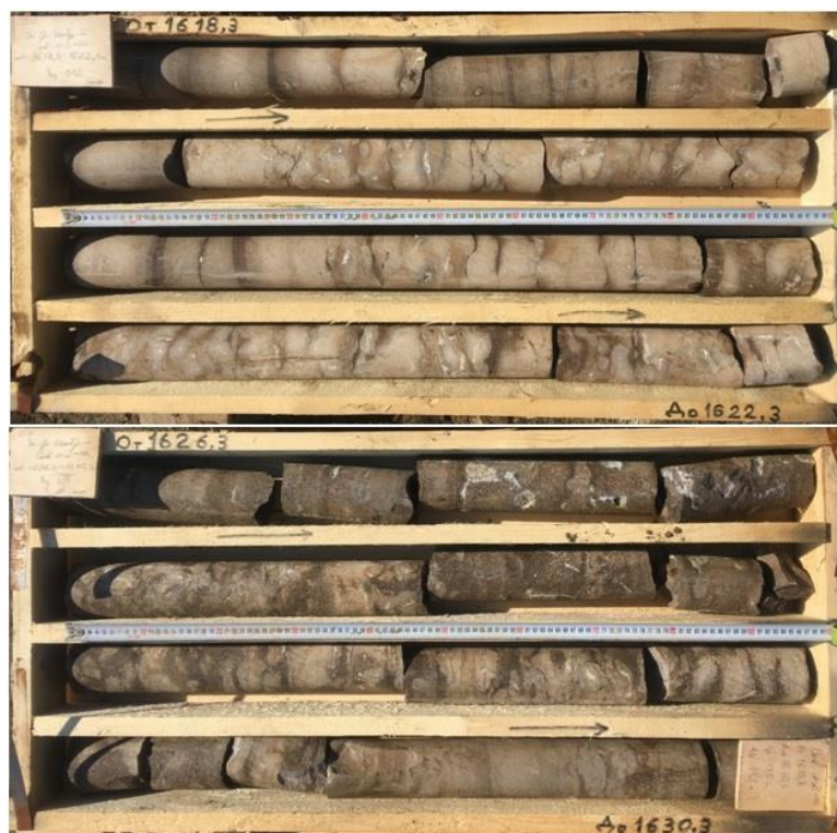
Рис. 2. Известняки водорослевые: интервал 1618.3–1622.3 м и 1626.3–1630.3 м. [Fig. 2. Algal limestones: interval 1618.3–1622.3 m and 1626.3–1630.3 m.]
