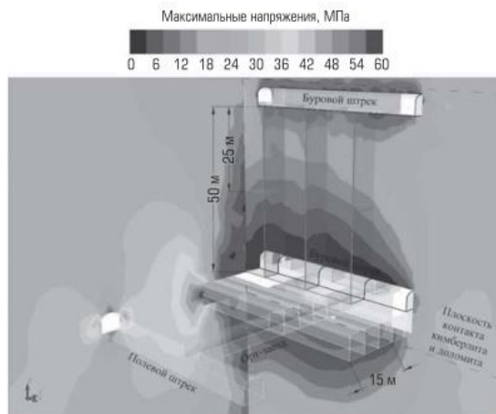
Рис. 6. Поле максимальных напряжений после формирования «разрезного слоя» во вмещающих породах на 15 м по обе стороны от рудного тела и проходки буровых штреков
