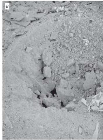
Рис. 2. Результаты взрыва сформированных гирляндных зарядов с применением Т400Г (а) и НПГМ-П-II-Б-60 (б)
