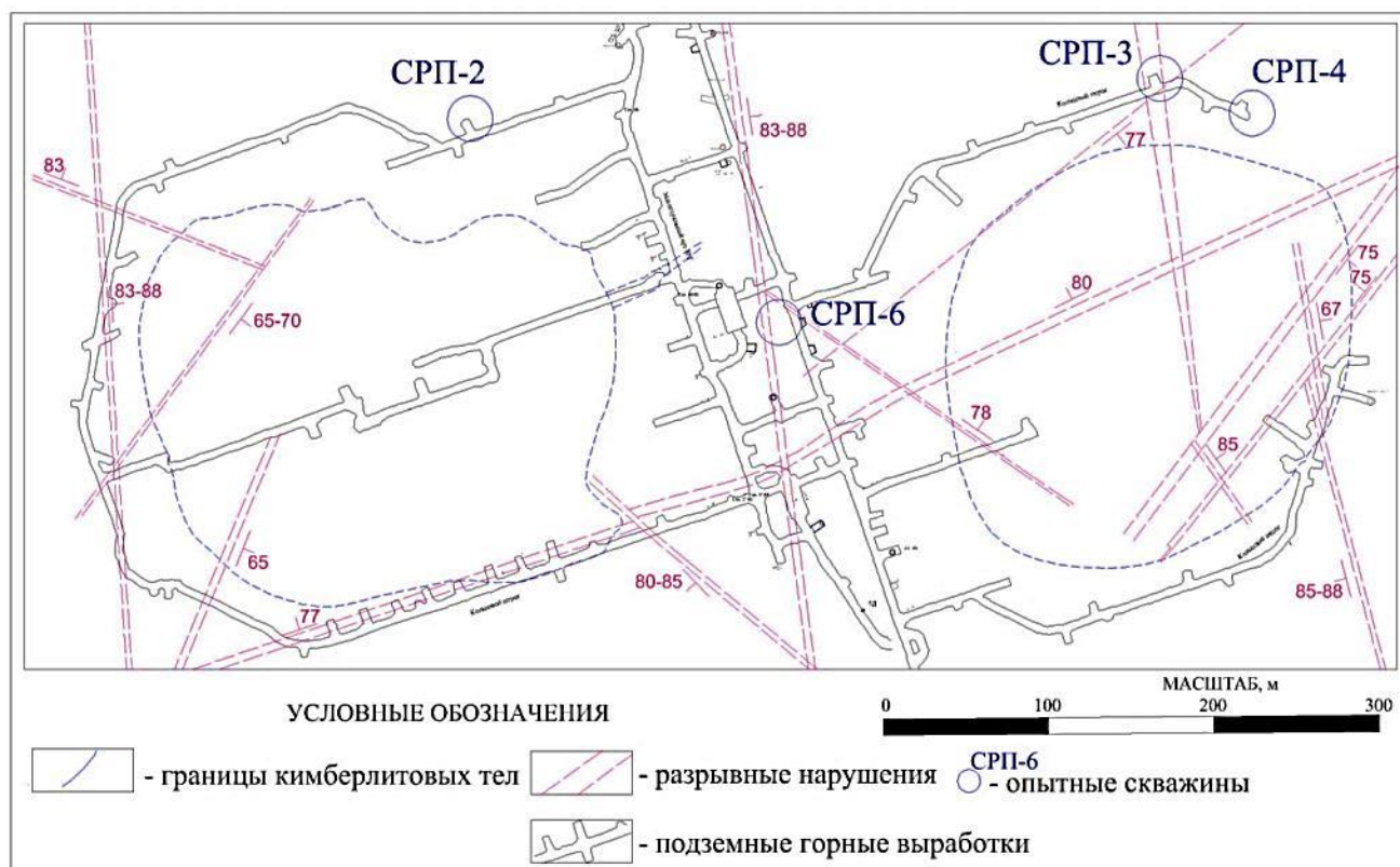
Рис. 3.5 Тектонические нарушения в пределах шахтного поля трубки «Удачная» (по материалам Удачинского ГОКа, ИЗК СО РАН, Мирнинской ГРЭ, Виллойской ГРЭ, МСШСТ).
