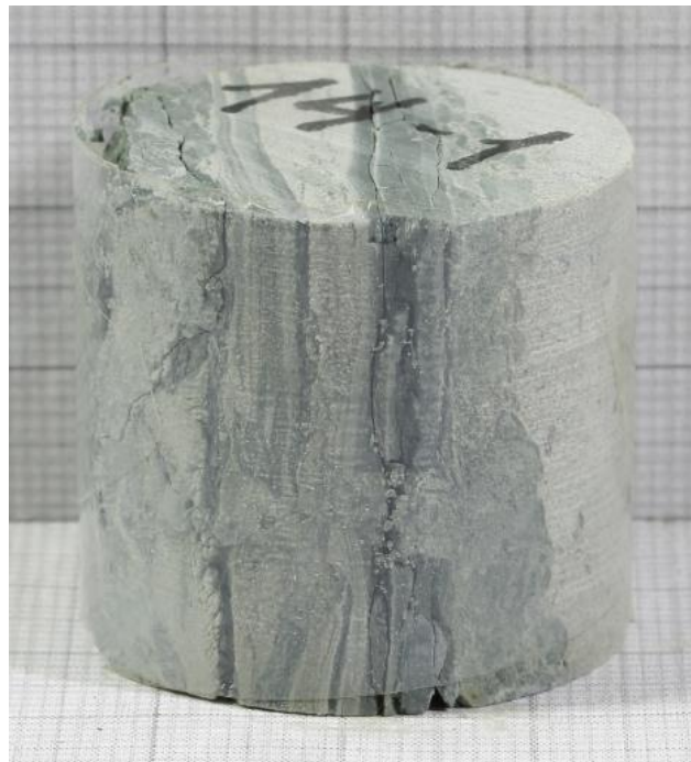
Рис. 2.28 Известняк с открытыми кавернами (скв 14н, глубина отбора 151 м).
