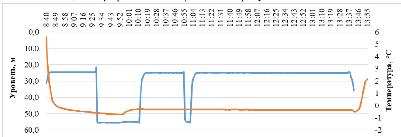
Рис. 5.19 Временное прослеживание откачки по скважине №4 при глубине скважины 100 м.
