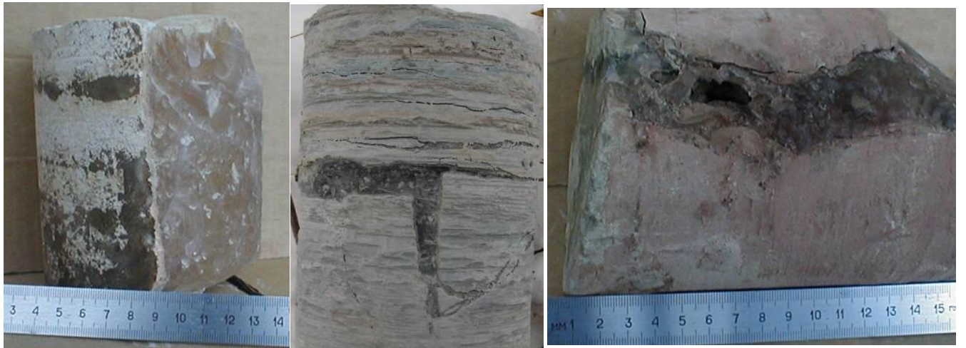
Рис. 2.6 Трещины, каверны, заполненные льдом, фиксируемые в керне скважин.
