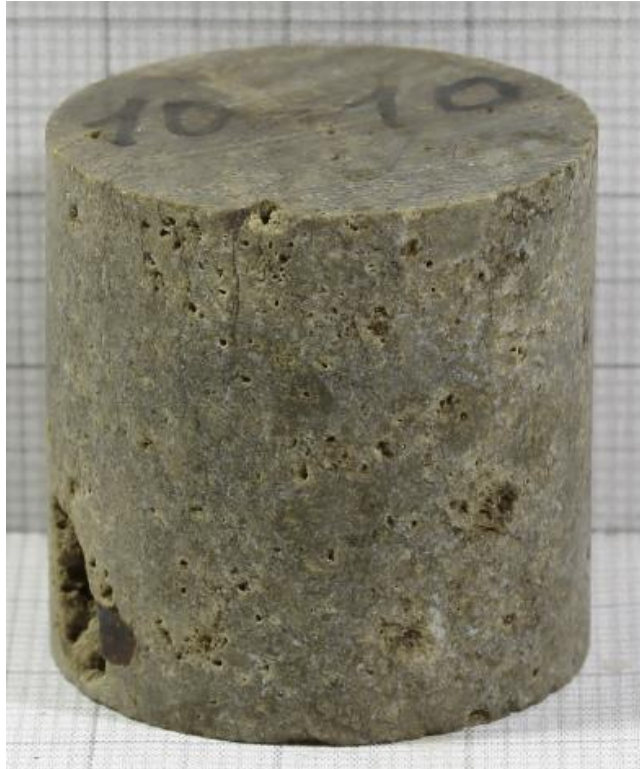
Рис. 2.27 Известняк с открытыми кавернами (скв 10н, глубина отбора 242 м).
