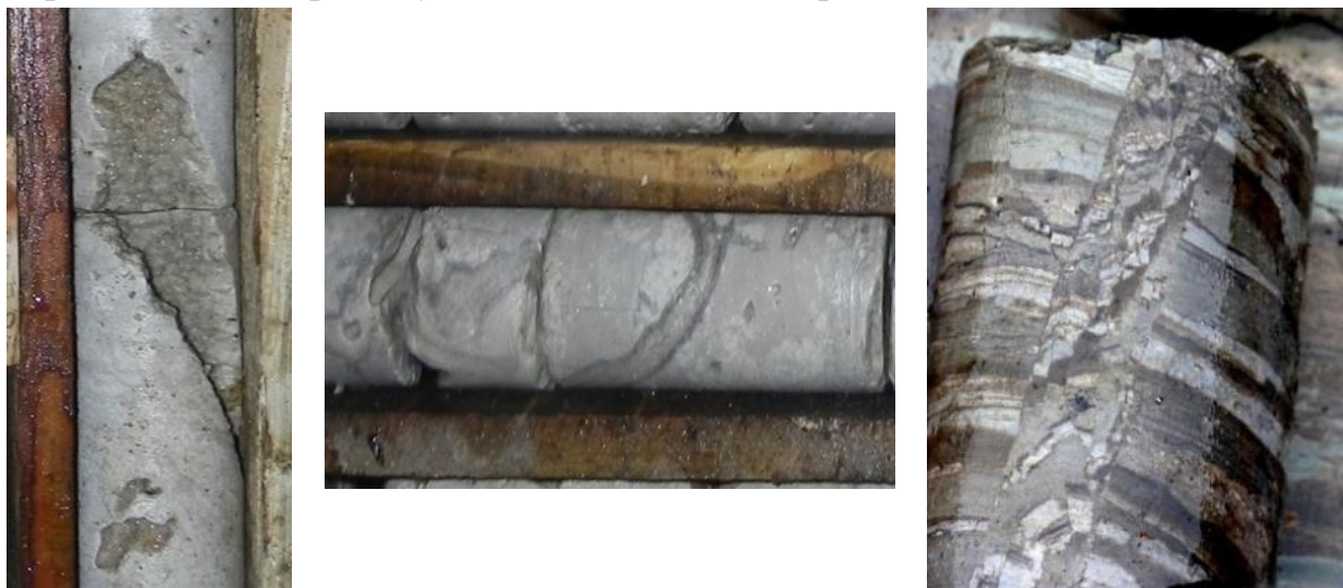
Рис. 3.8 Вмещающие породы в зоне тектонических нарушений (кern слева – открытые полости; образцы справа – трещины залечены).
