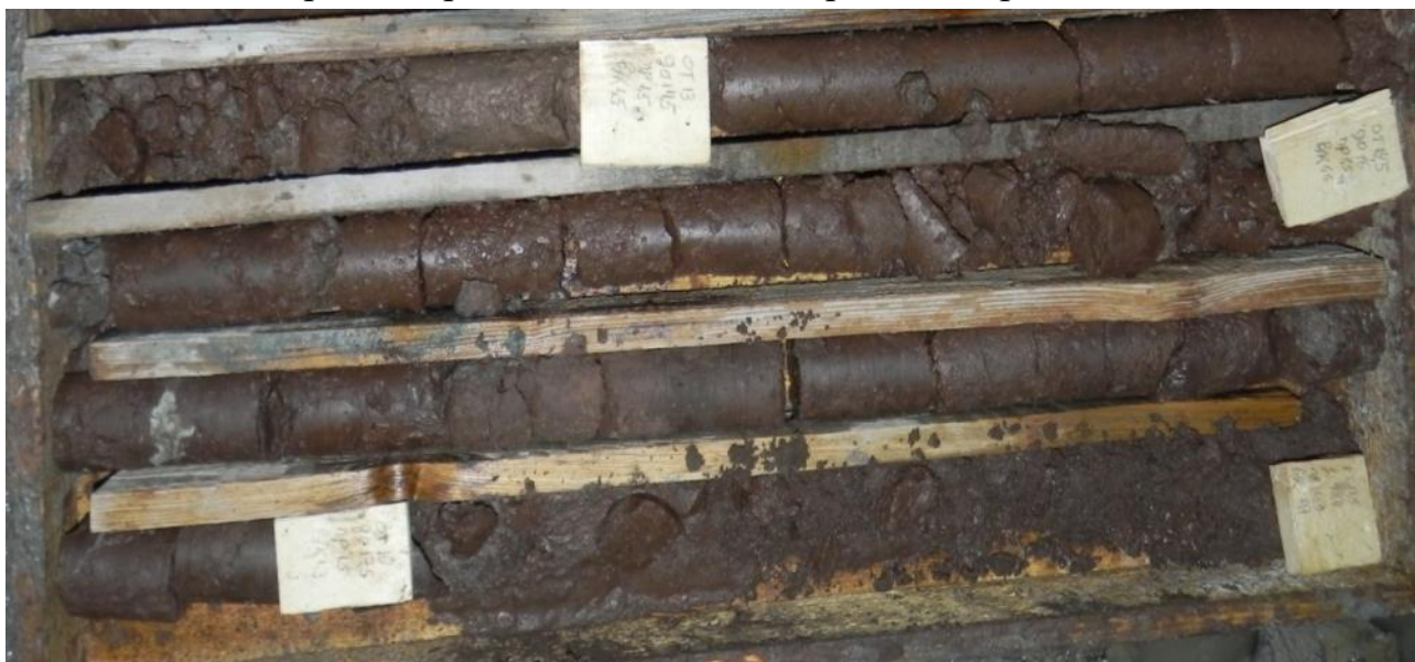
Рис. 3.64 Крупный ксенолит осадочных пород типа «плавающего рифа» скважина №СГК-1 (инт-л 4,0-18,4 (а.о. /-469,0/ - /-483,4/) м).
