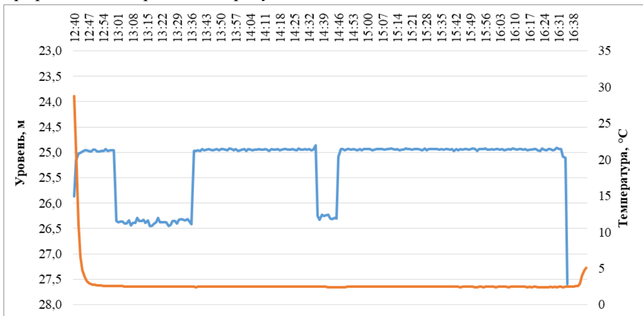
Рис. 5.15 Временное прослеживание откачки по скважине №4 при глубине скважины 60 м.
