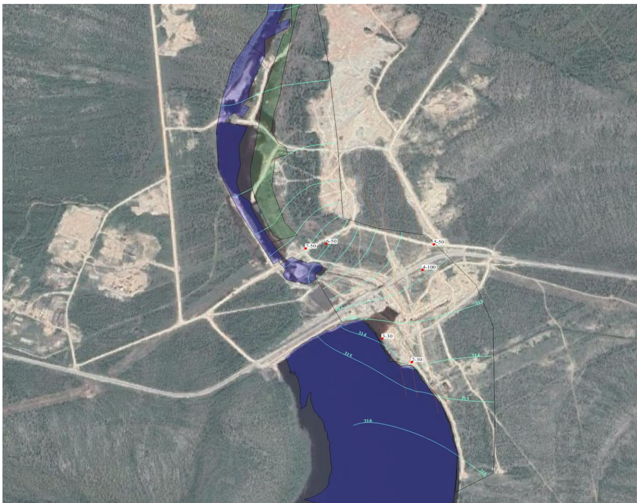
Рис. 5.20 Распределение уровней в природно-техногенном талике по результатам моделирования.
